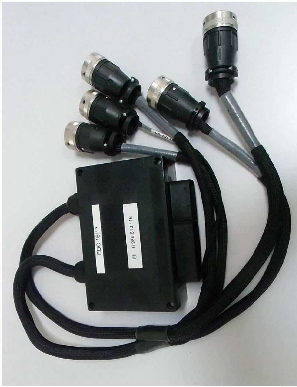
**Adapterleitung- Motorsteuergerät- EDC16 + EDC17, Hako- Ersatzteil- Nummer 03503520**
